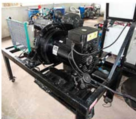
Motor *flex* adaptado para geração de energia elétrica, acoplado a um gerador trifásico de 42 kVA em fase de teste.
